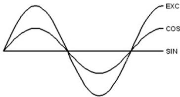
Bild 5.5: Motor-Drehlage bei 0
